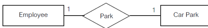
ภาพที่ 2.86 แสดงความสัมพันธ์ของพนักงานและที่จอดรถแบบหนึ่งต่อหนึ่ง (One-to-One Relationship)
